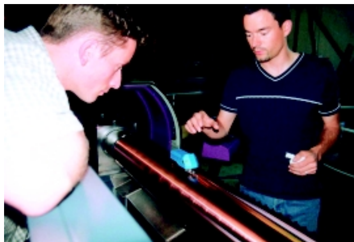
Rauhigkeitsmeßgerät: Messung der Rautiefe einer Tiefdruck-Kupferoberfläche.
