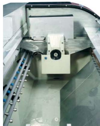
Abbildung 5 (links): Der Ecopolisher sorgt für definierte Zylinderoberflächen.
