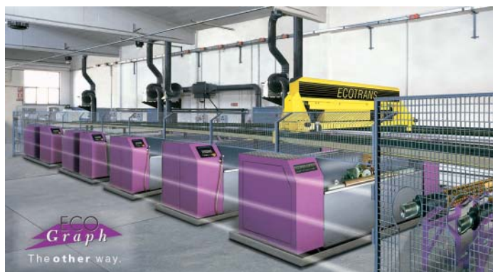
Abbildung 1: Eine Fertigungslinie von Ecograph zur Herstellung von Tiefdruckzylindern.
